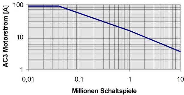
**Bild 1:** Lebensdauer bei AC3-Betrieb
