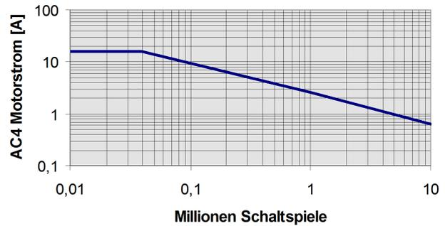
**Bild 2:** Lebensdauer bei AC4-Betrieb
